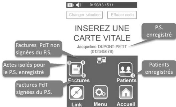
En mode déconnecté, **eS-KAP-Ad** passe automatiquement en mode veille. Il sort de veille par l'insertion d'une carte, un appui court sur le bouton latéral ou une connexion au poste de travail. Appuyer sur la touche « **Déverrouiller** » si nécessaire.
